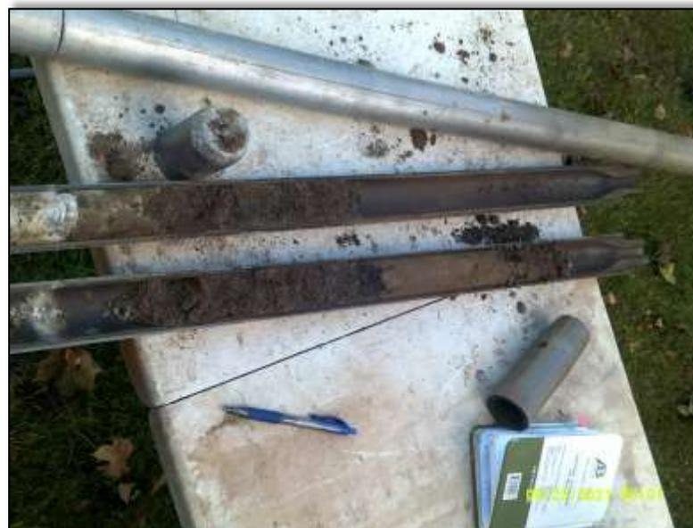
PHOTO #14: Échantillon de sable graveleux prélevé dans le carottier fendu
