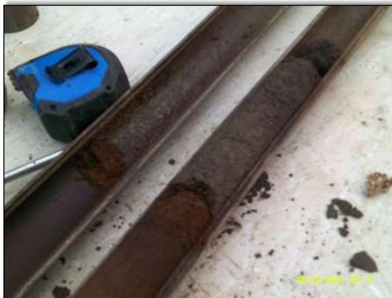
PHOTO #12: Échantillon de sable fin prélevé dans le carottier fendu
