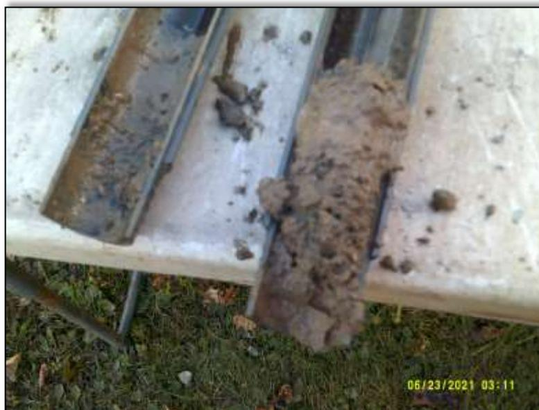
PHOTO #16: Échantillon de sol prélevé dans le carottier fendu
