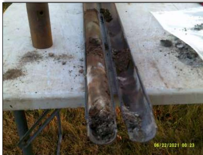
PHOTO #10: Échantillon de sol prélevé en continu dans un carottier fendu
