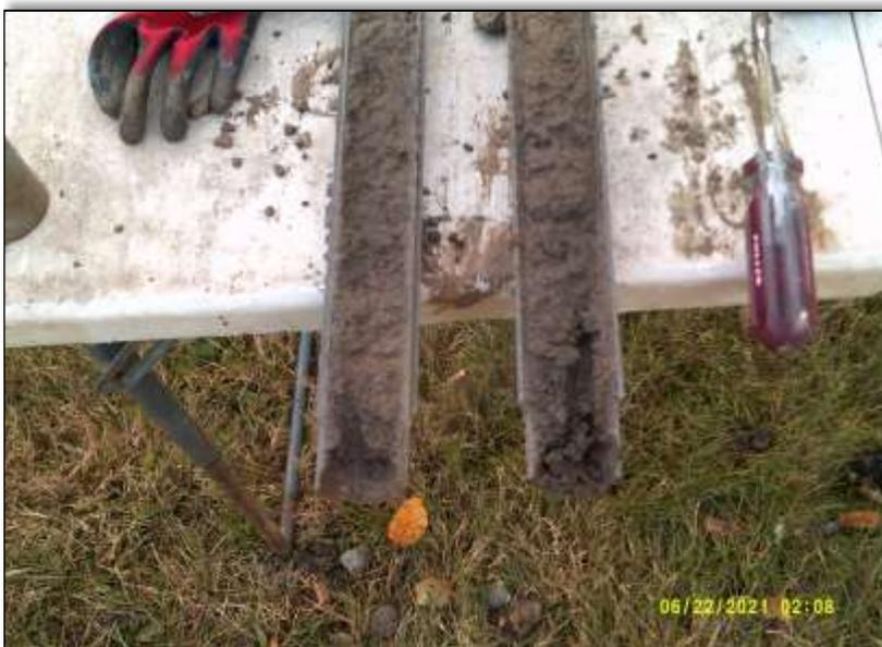
PHOTO #11: Échantillon de sable fin prélevé dans le carottier fendu
